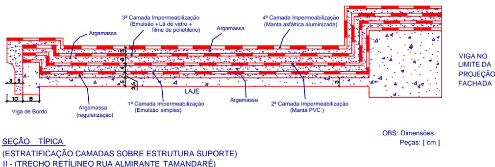
**Figura 1 – Estratificação de camadas sobrepostas à estrutura de marquise.**
