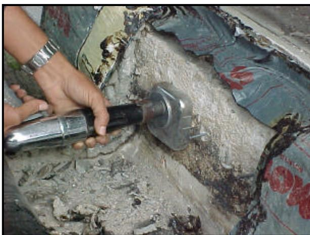
Foto 8 – END de penetração de pinos para avaliação da resistência do concreto.
